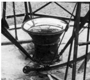
Fig. 7 - Gresol per a fusió de mostres, aquí equipat amb una cúpula transparent per a fusions en atmosfera controlada
