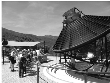
Fig. 16 - El forn solar en demostració
